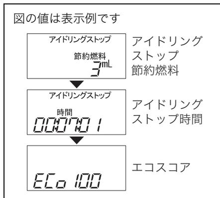
上図のように表示されている間、エコドライブアシスト照明が点灯します。
