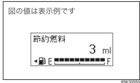
表示をリセットしてからのアイドルストップによる節約燃料の累計が mL 単位で表示されます。
