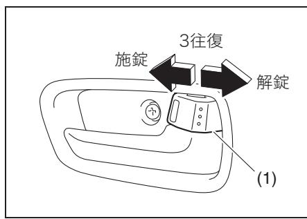
前記の手順を行なうと、モード設定が次表の順で切り替わります。また、設定確認ブザーの回数によって設定状態が確認できます。
