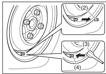
**6** コア回し (3) でバルブコア (4) を反時計方向にまわして外します。
