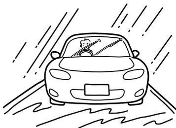
ぬれた路面や凍結路、積雪路などのすべりやすい路面では、急加速や急ブレーキ、急ハンドル、急激なエンジンブレーキを避け、スピードをひかえめにして運転してください。ぬれた路面を高速で走行すると、タイヤと路面の間に水の膜ができ、タイヤが浮いた状態（ハイドロプレーニング現象）になるおそれがあります。
