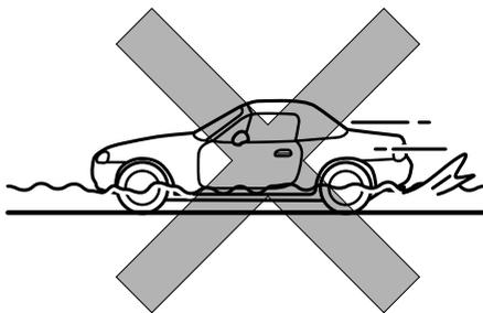
冠水した道路を走行しないでください。冠水した道路を走行すると、エンストするだけでなく、電気部品や電子部品のショート、水を吸い込んでのエンジン破損など、車両に悪影響をおよぼします。万一、水中に浸ってしまったときは、必ずマツダ販売店へご相談ください。
