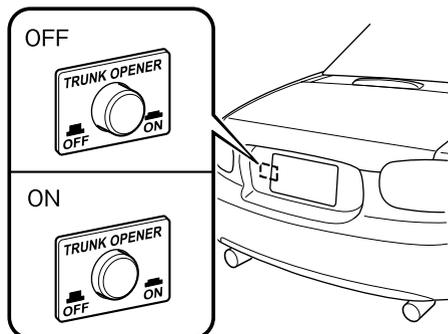
スイッチをONの位置にすると、トランクオープナースイッチで、トランクが開きます。
