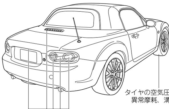
タイヤの空気圧、き裂、損傷
