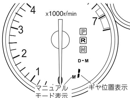
高速走行中、速度によりシフトダウンできないときは、ギヤ位置表示が2回点滅します。
