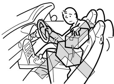
荷物を積むときは、助手席にそのまま置いたり積み重ねたりせず、確実に固定してください。走行中に荷物が移動したりくずれたりしてけがや思わぬ事故につながるおそれがあります。
