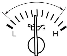
エンジン始動後に針が動かないとき、または運転中に針が“L”付近を示したときは、ただちに安全な場所に停車し、エンジンを止めエンジンオイル量を点検してください。オイルが不足しているときは補充してください。
