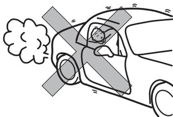
エンジンをかけたままで仮眠しないでください。無意識にチェンジレバー/セレクタレバーを動かしたり、アクセルペダルを踏み込み車が発進したり、エンジンや排気管の異常過熱による火災など思わぬ事故につながるおそれがあります。
