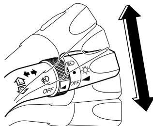
電源ポジションがONのとき使用できます。レバーを操作すると、左または右のメーター内の方向指示灯が点滅し、手を離すと消灯します。
