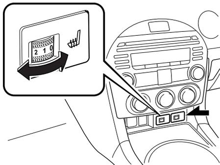
エンジンスイッチがONのとき、ダイヤルをまわすと作動します。ダイヤルの数字が大きいほど、温度が高くなります。ダイヤルを0の位置にすると、作動が停止します。
