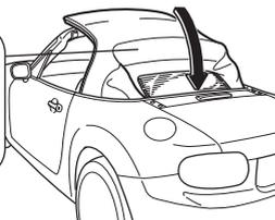
4 ソフトトップを後側から前側の順に、カチッと音がするまで押さえつけ、確実に固定します。
