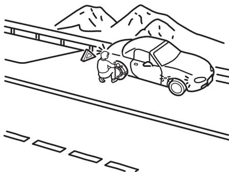
タイヤチェーンは後輪に取り付けます。タイヤチェーンはタイヤサイズに合った純正品を使用してください。タイヤチェーンに付属の取扱説明書にしたがって正しく取り付けてください。タイヤチェーンの取り付けは、交通のさまたげにならず、安全に作業ができる平らな場所で行なってください。路上で行なう場合は、非常点滅灯、停止表示板(停止表示灯)を使用してください。
