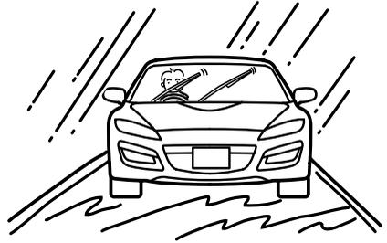
ぬれた路面や凍結路、積雪路などのすべりやすい路面では、急加速や急ブレーキ、急ハンドル、急激なエンジンブレーキを避け、スピードをひかえめにして運転してください。ぬれた路面を高速で走行すると、タイヤと路面の間に水の膜ができ、タイヤが浮いた状態(ハイドロプレーニング現象)になるおそれがあります。
