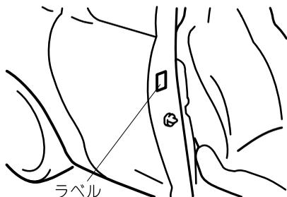
タイヤの空気圧が不足したままで走行しないでください。タイヤの空気圧が不足していると車両の安定性を損なうばかりでなく、タイヤが偏摩耗したりします。また、タイヤの空気圧が不足したままで高速走行すると、タイヤがバースト(破裂)するなどして、思わぬ事故につながるおそれがあります。適正空気圧は、運転席側のリヤドアに貼付されているラベルで確認してください。
