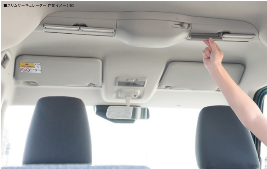
■スリムサーキュレーター 作動イメージ図
