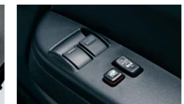
8 フロントパワーウィンドー (運転席:キーOFF後作動可能ワンタッチ式/挟み込み防止機構付)
