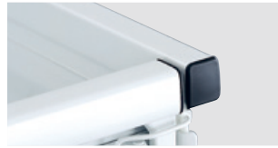
樹脂カバー(ゲート先端部分) 〈全車標準装備〉
