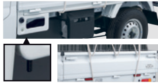
荷台ロープフック×19/荷台平シートフック ×2〈全車標準装備〉
