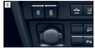
アクセサリソケット(インパネ)〈全車標準装備〉 USBチャージャー(Type-A:フロント×1、 Type-C:フロント×1)〈標準装備:KX〉
