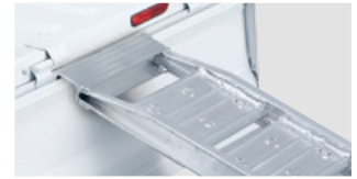
みち板引掛式リアゲート 〈全車標準装備〉
