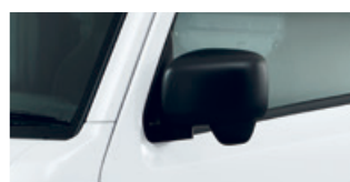
電動格納リモコン式ドアミラー (材着ブラック) 〈標準装備:KX〉
