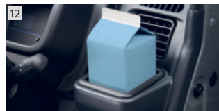
12 インパネドリンクホルダー(運転席側/ 助手席側)〈全車標準装備〉 500mlの紙パックに対応。
