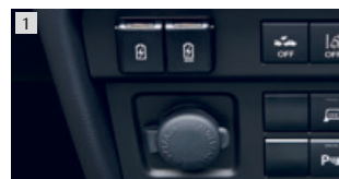
1 アクセサリーソケット(インパネ)〈全車標準装備〉 USBチャージャー(Type-A:フロント×1、 Type-C:フロント×1)〈標準装備:KX〉
