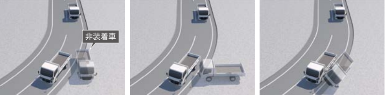
アンダーステアの場合 オーバーステアの場合 転倒の場合
