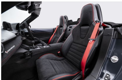
MAZDA SPIRIT RACING専用RECARO社製シート/ シート材質(アルカンターラ®/ナッパレザー) ※1
