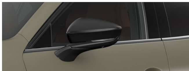
電動格納リモコン式カラードドアミラー(ピアノブラック)
