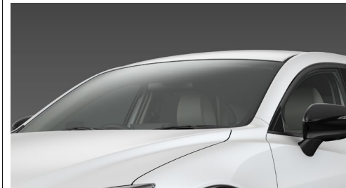
スーパーUVカットガラス(フロントドア) IRカットガラス(フロントガラス/フロントドア)
