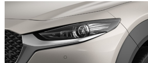
アダプティブ・LED・ヘッドライト(ALH) / ヘッドランプユニット内シグネチャーLEDランプ
