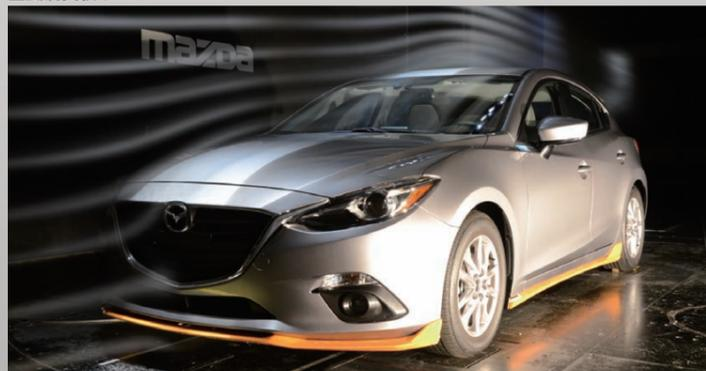
フルセットでの装着により、空力のベストバランスを実現します。コンピューター解析 (CFD) の駆使と、風洞実験により形状を最適化することでCd値を変えずに揚力を大幅に低減。新型アクセラのダイナミック性能をより引き上げました。
