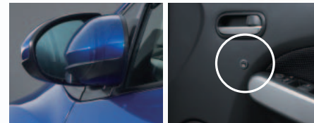
オートミラー格納イメージ システムスイッチ部 [通常の視野範囲]でミラーを確認したい場合に使用。
