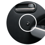
スイッチ部 ※リバース連動ミラーの「ON」「OFF」設定ができます。
