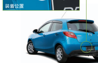
※モニター画面（画像はイメージです。） 擬似バンパーライン ※実際のバンパーラインより20cm程度後方の位置を示しています。
