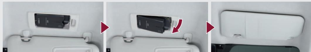
サンバイザーに隠れる天井部にETC2.0(DSRC)/ETC車載器をスマートに収納。簡単にETCカードの出し入れが可能です。
