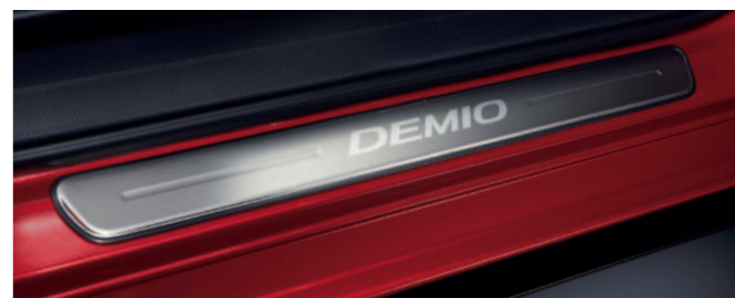
42 スカッフプレート ドアを開けた瞬間を彩るスカッフプレート。ヘアライン仕上げのステンレス製。DEMIOロゴのフロント用2枚セット。
