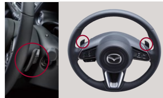
45 ステアリングシフトスイッチ 素早いシフトや的確なブリッピング制御など、SKYACTIV-DRIVEならではの特徴をMT車を味わうように楽しめます。Dレンジのままでもステアリングスイッチ操作による一時的な変速が可能なダイレクトモードに対応しています。
