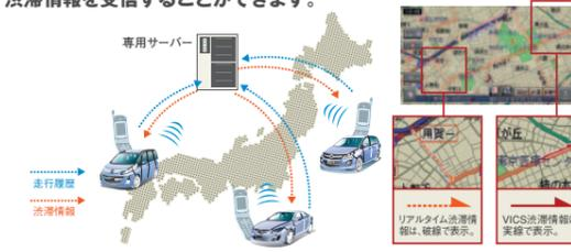
HDDに収録されている渋滞予測データに加えて、リアルタイムプローブはBluetooth®対応携帯電話により専用サーバーを介し、他のナビゲーターから寄せられるリアルタイムな渋滞情報を取得。通常のVICSでは得られない広域エリアの渋滞情報により最も早く目的地に着くルートを提供します。
