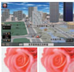
通常の車載モニターの約4倍、115万画素の高精細VGAモニターを搭載。緻密な地図画面や3D描画をなめらかに見やすく表示するとともに、地上デジタル放送やDVDビデオの映像も臨場感豊かな鮮明画像で映し出します。また、上下・左右どの方向からも見やすい広視野角LCDを採用。運転席からも助手席からも、またナビ取付け面が傾斜している車種でも、きれいな映像が見られます。
