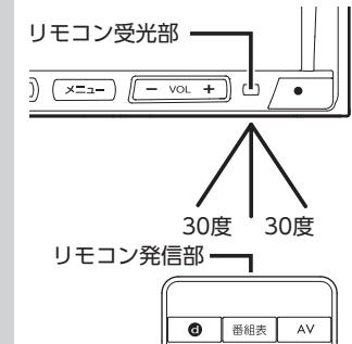
リモコンの発信部は、上下左右30度の範囲で、リモコン受光部に向けて操作してください。
