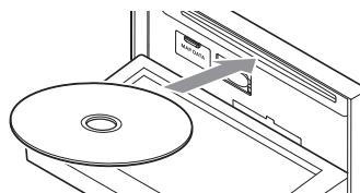
ディスクが取り込まれ、操作パネルが自動的に閉じます。しばらくすると、ディスクの再生がはじまります。
