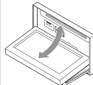
操作パネルを閉じるには、もう一度▲または[OPEN■TILT]を押すか、[パネル開／閉]をタッチします。
