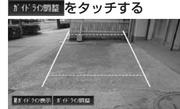
5 画面に表示されているガイドポイント（4箇所）を▼▲◀▶をタッチして調整し、マーキングした4点と合わせる
