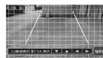
D : 選択中のガイドポイントを上下左右に移動します。タッチし続けると、5倍の速さで連続して移動させることができます。
