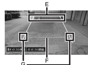
E : 車両後端より約2mの位置を示します。
