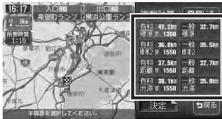
各ルートには、総走行距離と料金が表示されます。実際の料金が表示より多い可能性がある場合は、「¥〇〇以上」と表示されます。
