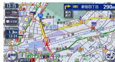
「オートスケール」誘導の場合に、進行方向上向きで地図を表示していると、約300m手前で曲がる方向を広く表示するように地図が左右に移動します(サイドワイド機能)。ただし、方面看板が表示されているときの左折案内では、地図は移動しません。
