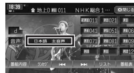
受信される番組は、それぞれ音声種類を持っています。「音声」をタッチするたびに12セグ放送は最大16音声まで、ワンセグ放送は2音声まで切り替えられます。また、音声多重放送時には各音声の主音声と副音声を切り替えられます。
