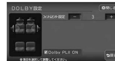
ファントムセンター：センターチャンネルの音声を振り分けるスピーカーを設定します。
