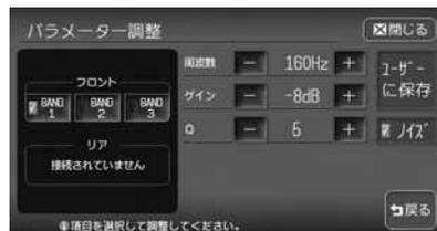
[周波数]：中心周波数（補正したい周波数帯＜バンド＞の中心となる周波数）を、BAND1では20Hz～20kHz、BAND2および3では125Hz～20kHzの範囲で調整します。1/3オクターブずつ調整できます。
