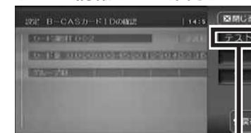
B-CASカードの通信テストを行います。通信テストがエラーの場合、番組放送画面に戻るときにメッセージが表示されます。メッセージの内容にしたがって対処してください。
