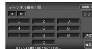
12セグ放送の3桁チャンネル番号を入力した場合、放送局があるとオーディオ画面に切り替わり選局した放送を受信します。ワンセグ放送の3桁チャンネル番号を入力した場合は、放送局があると選局はされますが画面は切り替わりません。**決定** をタッチしてください。放送局がない場合は、入力した番号がキャンセルされるので再入力します。
