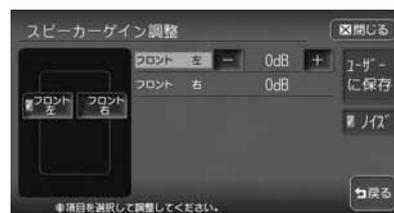
各スピーカーのテストトーンがすべて同じになるように調整します。
