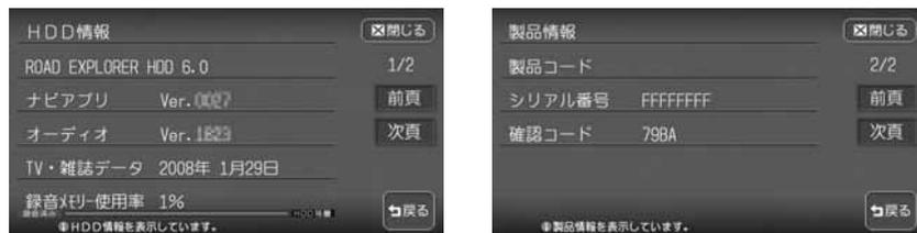
ハードディスク情報が表示されます。地図データの情報、TV・雑誌データの最終更新日、ミュージックキャッチャーとファイルキャッチャーのメモリー使用率の合計が表示されます。
