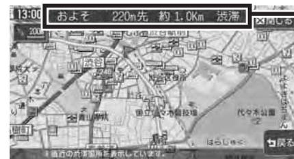
渋滞の起点までの距離と渋滞距離を表示します。
