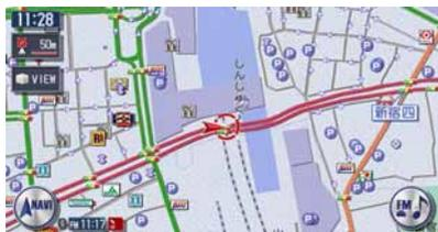
一方通行の道に矢印を表示します。50m以下のスケールで表示されます。
