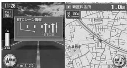
※ ETC連動時(ETCユニットが接続され、かつETCカードが挿入されている状態)は料金の表示のみとなり、音声案内は行いません。
