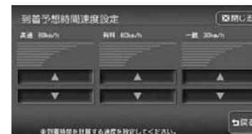
高速：高速道走行時の速度を60～100km/hに設定できます。
