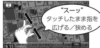
画面に2本の指をタッチしたまま広げる（ピンチアウト）と、地図が拡大し、狭める（ピンチイン）と、地図が縮小します。
