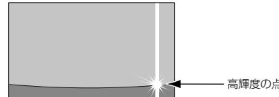
※ スミヤ現象：高輝度の点（車体に反射した太陽等）がカメラに映るとその点の上下（縦方向）に尾を引く現象。
