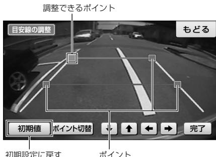
● [ポイント切替] にタッチするごとに、調整できるポイントが切替わります。
