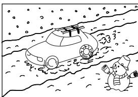
雪道などの滑りやすい路面を走行しているときや、タイヤチェーンなどを装着して走行しているとき、現在地がずれて表示される。
