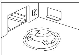
駐車場のターンテーブルなどで、ACC OFFの状態で旋回したとき、現在方位がずれて表示される。
