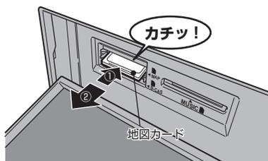
地図カードが飛び出し、抜き取れる状態になります。ゆっくりと抜いてください。
