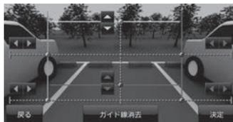
リアカメラ映像にガイド線を表示します。再度消去する場合は、[ガイド線消去]にタッチします。
