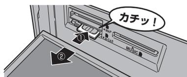
カードが飛び出し抜き取れる状態になります。ゆっくりと抜いてください。
