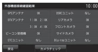
本機に接続されている外部機器の接続状態を表示します。
