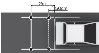
リアカメラの映像でも認識しやすいように少し大きめの「×」印を付けることをおすすめします。
