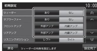
「システム構成図」(P32) を確認し、実際に取り付けているスピーカーシステム通りの設定を行ってください。
