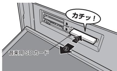
音楽用 SD カードが飛び出し、抜き取れる状態になります。ゆっくりと抜いてください。
