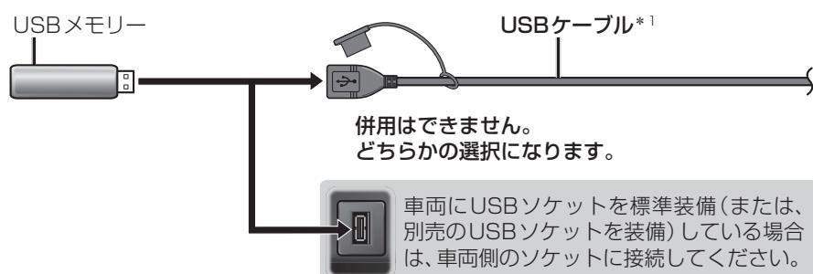
\* 1 グローブボックス等から出ている付属のUSBケーブルを引き出して接続してください。
