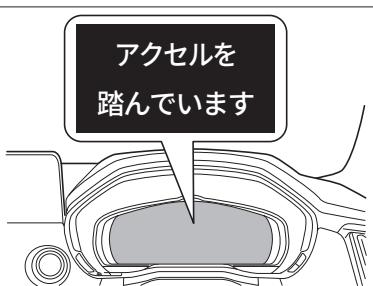
急アクセル時加速抑制が作動したときは、ブザーでお知らせするとともに、メーター内にメッセージが表示され、マツダ・レーダー・クルーズ・コントロールが解除されます。
