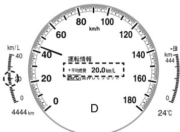
表示されている平均燃費のデータをリセットするには、INFOスイッチを1.5秒以上押します。データをリセットすると、平均燃費を再算出して表示するまでの約30秒間は、「---km/L」を表示します。
