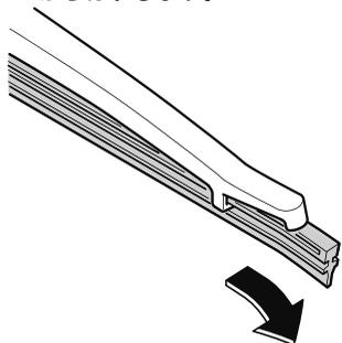
3. ブレード部品からブレードラバーを取りはずし、新しいブレードに取り付けます。
