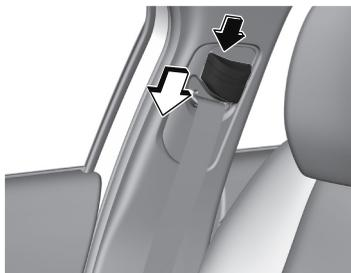
調節した後は、シートベルトアンカーアジャスターを下方に押し、確実にロックされていることを確認してください。
