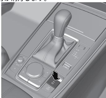
ブレーキペダルを踏み込まずに EPB スイッチを押すと、マルチインフォメーションディスプレイにメッセージが表示され、ブレーキペダルを踏み込むよう運転者にお知らせます。
