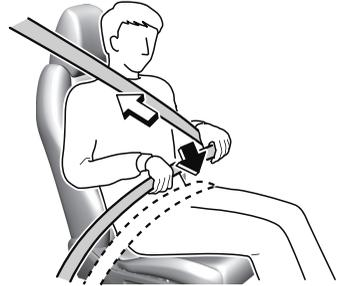
リアシートのシートベルトは、着用する前にシートベルトがシートベルトガイドに正しく通っていること、ねじれていないことを確認してください。
