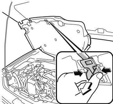
4. ストラップをボンネットのフックに引っ掛け、カバーを固定します。
