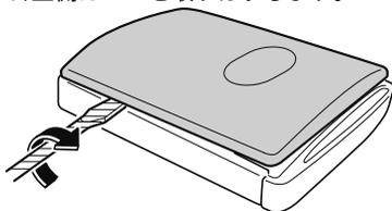
5. 保護テープを巻いたマイナスドライバーを使って、キャップを取りはずします。
