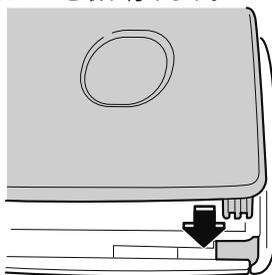
10. キーのスロットに下側カバーのツメを差し込むように、下側カバーを取り付けます。
