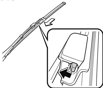
4. ブレードゴムを矢印の方向に引っ張り、ブレードホルダーの溝が確認できる位置までブレードゴムをスライドさせます。
