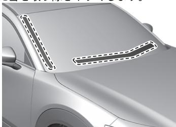
電源ポジションを ON にして、リアウインドーデフォグガー (曇り取り) スイッチを押すとウィンドーワイパーデアイサーが作動します。
