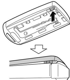
3. 保護テープを巻いたマイナスドライバーをすき間に差し込み、マイナスドライバーを矢印方向にスライドさせます。
