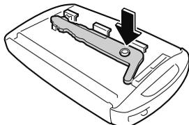
2. キーのスロットに下側カバーのツメを差し込むように、下側カバーを取り付けます。
