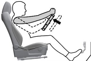
2. メーター類がしっかり見えるように、ハンドルの高さを調節します。
