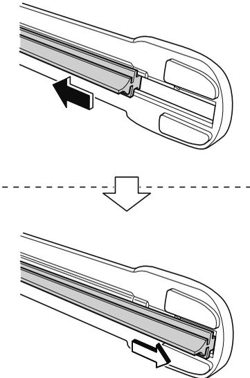
8. ブレードホルダーにブレードゴムが正しく取り付けられているか確認します。
