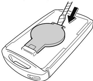
6. 保護テープを巻いたマイナスドライバーを使って、電池を取りはずします。
