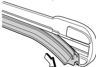
6. ブレードホルダーの溝から、新しいブレードゴムの先端を挿入し、ブレードホルダー
