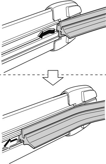
7. ブレードゴムを矢印の方向へ引っ張り、ブレードホルダーの溝が確認できる位置までブレードゴムをスライドさせた後、ブレードゴムの先端を逆方向にスライドさせます。
