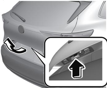
キーを携帯して電磁式リアゲートオープナーを押すと、施錠されている状態でもリアゲートを開けることができます。
