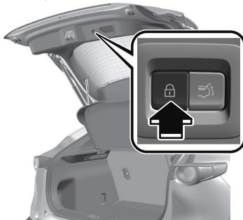
ロックスイッチを使って施錠する場合は、次の条件をすべて満たしてロックスイッチを押してください。施錠が行なわれた後、リアゲートは自動で閉まります。
