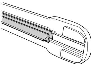
5. ブレードホルダーの溝から、ブレードゴムの先端を矢印の方向に引き、ブレードホルダーからブレードゴムを取りはずします。
