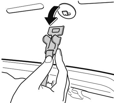
2. ストラップのツマミを指ではさみ、カチッと音がするまでホルダーに押し込みます。
