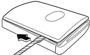
4. マイナスドライバーを矢印方向にまわして、上側カバーを取りはずします。
