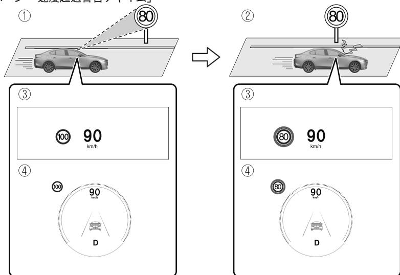
1. 90 km/h で走行中、80 km/h の最高速度標識を認識
