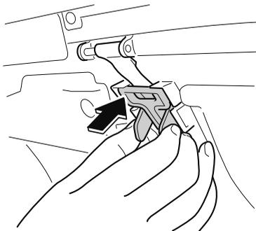
3. エンジンカバーを閉め、ノブをまわしてカバーをロックします。
