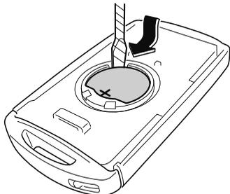
7. 電池の+側が上になるように、キーに新しい電池をはめ込みます。
