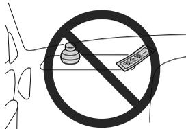
車両前部にグリルガードなどを装着しない。SRS エアバッグシステムに影響をおよぼすため、万一の場合エアバッグが正常に作動しなくなり、重大な傷害につながるおそれがあります。
