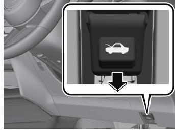
2. ボンネットのすき間に手を入れ、レバーを矢印の方向に倒したままボンネットを持ち上げます。
