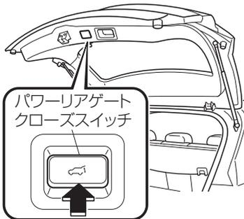
パワーリアゲートクローズスイッチを押して、スイッチから手を離すと、非常点滅灯が2回点滅し、ブザーが鳴ったあと、自動で閉まります。
