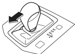
セレクトレバーを十側に動かすとシフトアップ (高速ギアに変速) します。
