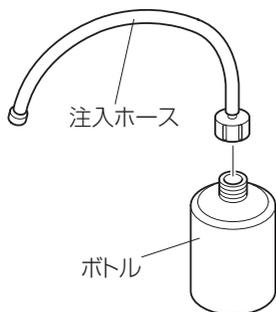
9. ボトルのキャップをはずします。内ぶたをつけたままの状態では注入ホースをボトルにねじ込むと、ボトルの内ぶたが破れます。
