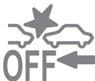
スマート・シティ・ブレーキ・サポート [後退時] (SCBS R) を作動しないようにすると、スマート・シティ・ブレーキ・サポート (SCBS) OFF 表示灯が点灯します。
