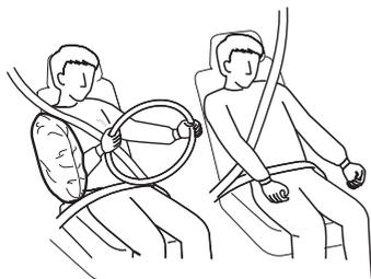
サイドエアバッグはフロントシート背もたれの外側部分に格納されています。乗員の有無に関係なく衝撃を受けた側のサイドエアバッグが膨らみます。
