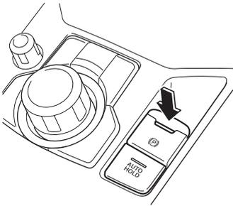
ブレーキペダルをしっかりと踏み込み、電動パーキングブレーキ (EPB) スイッチを押します。
