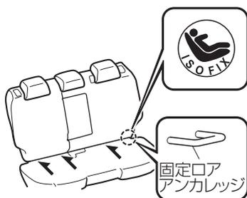
3. シートクッションにある縦の切れ目を広げて、固定ロアアンカレッジの位置を確認します。
