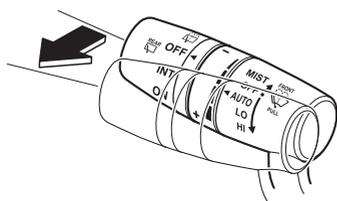
電源ポジションがONでヘッドライトが点灯しているときに、レバーを手前に2回引くとヘッドランプウォッシャーが作動します。
