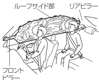
カーテンエアバッグはフロントピラー、ルーフサイド部、リアピラーに格納されています。乗員の有無に関係なく衝撃を受けた側のカーテンエアバッグが膨らみます。
