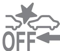
アドバンスト・スマート・シティ・ブレーキ・サポート（アドバンスト SCBS）を作動しないようにすると、スマート・シティ・ブレーキ・サポート（SCBS）OFF 表示灯が点灯します。
