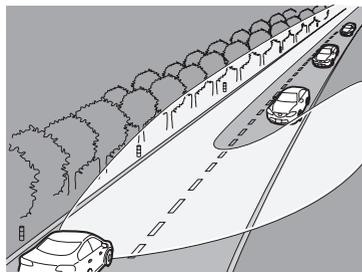
ヘッドランプ上向き (ハイビーム) の配光を前方車の部分だけ減光して照射します。車速約40 km/h以上で作動します。車速が約30 km/h未満になると、下向き (ロービーム) に切り替わります。
