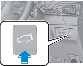
パワーリアゲートスイッチを約1秒以上押すと、非常点滅灯が2回点滅し、ブザーが鳴ったあと、自動で全開（全閉）します。
