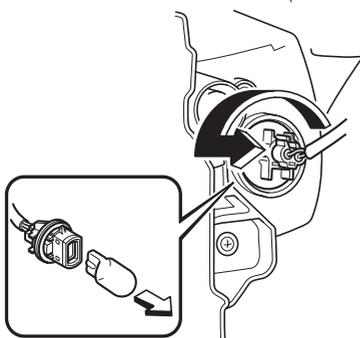
2. ソケットを反時計回りにまわして取りはずし、電球を抜き取ります。
