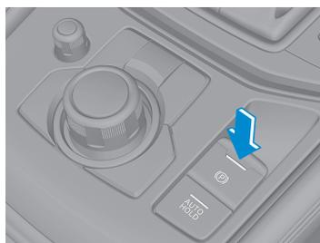
ブレーキペダルをしっかりと踏み込み、電動パーキングブレーキ (EPB) スイッチを押します。
