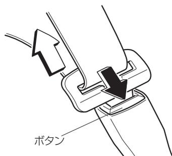
はずすときはバックルのボタンを押します。ベルトにねじれがないかを確認しながら、ゆっくりと巻き取らせてます。
