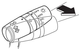
電源ポジションが ACC または OFF のときに、レバーを引くとヘッドランプが下向き（ロービーム）で点灯します。ドアを開けてから一定時間経過すると消灯します。
