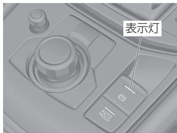
電動パーキングブレーキ (EPB) とは、電気モーターでパーキングブレーキをかける装置です。スイッチの表示灯は、電動パーキングブレーキ (EPB) をかけると点灯し、解除すると消灯します。電動パーキングブレーキ (EPB) スイッチ操作中は、スイッチの表示灯が点滅します。
