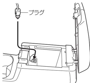
コンソールボックスの溝にコードを通し、コード先端のプラグを電源ソケットに接続します。
