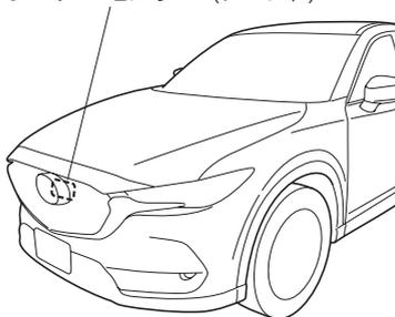
マルチインフォメーションディスプレイに「レーダー汚れレーダー前面を清掃してください」が表示されたときは、レーダーセンサー（フロント）付近を清掃してください。
