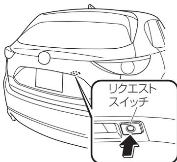
キーを携帯し、リアゲートのリクエストスイッチを押すと、すべてのドア、リアゲートが施錠します。
