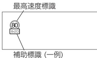
補助標識の条件（時間帯、右左折時、区間の終わりなど）をフォワードセンシングカメラ (FSC) が正しく分類できなかった場合、次の画面を表示します。
