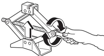
3. ジャッキの図の部分を手でまわしてジャッキをジャッキアップ指定位置の近くにするよう調節します。
