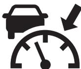
MODE スイッチを 1 回押すと、マツダ・レーダー・クルーズ・コントロール (全車速追従機能付) (MRCC (全車速追従機能付)) が ON になり、マツダ・レーダー・クルーズ・コントロール (全車速追従機能付) (MRCC (全車速追従機能付)) メイン表示 (白) が点灯し、速度の設定や追従走行時の車間距離の設定ができる状態になります。
