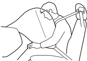
助手席エアバッグはインストルメントパネルに格納されています。助手席に同乗者がいなくても運転席エアバッグと同時に膨らみます。
