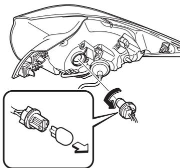
5. ソケットを反時計回りにまわして取りはずし、電球を抜き取ります。
