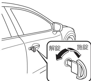
運転席ドアに、補助キーを差し込み、まわすとすべてのドア、リアゲートの施錠 / 解錠ができます。
