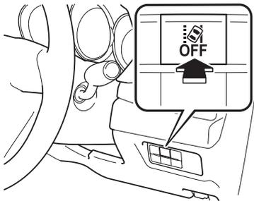
レーンキープ・アシスト・システム (LAS) & 車線逸脱警報システムを停止するときは、レーンキープ・アシスト・システム (LAS) & 車線逸脱警報システム OFF スイッチを押します。
