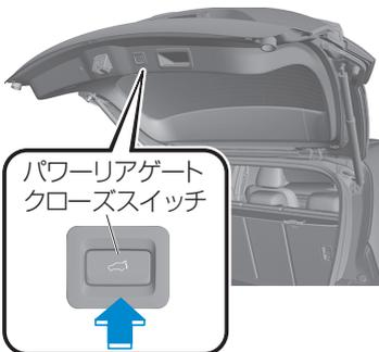
パワーリアゲートクローズスイッチを押して、スイッチから手を離すと、非常点滅灯が2回点滅し、ブザーが鳴ったあと、自動で閉まります。
