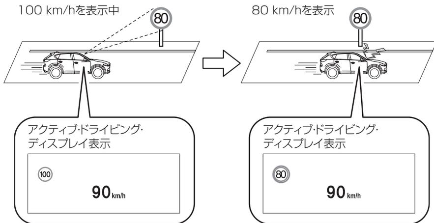
速度超過警報は初期設定で作動しないように設定されています。速度超過警報を作動させたいときは、カスタマイズ設定を行なってください。なお、警報パターンおよび警報タイミングは設定内容によって異なります。
