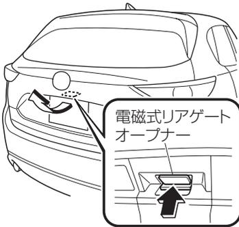
電磁式リアゲートオープナーを押してリアゲートを持ち上げます。
