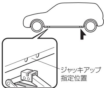
4. ジャッキをジャッキアップ指定位置（目印となるふくらみの間）の中央に直角にセットします。
