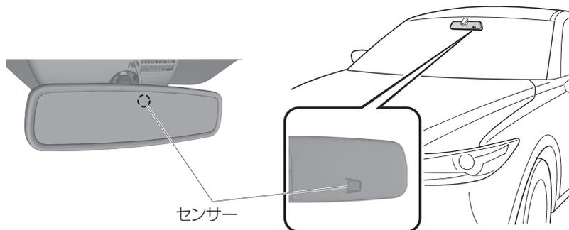
電源ポジションがONのとき、後続車からのヘッドランプの光を自動で軽減します。
