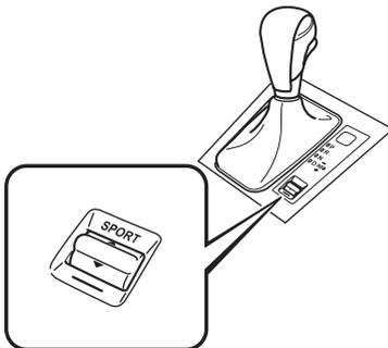
ドライブセレクションスイッチを**SPORT**側（前方）に押しすと、スポーツモードになります。ドライブセレクションスイッチを**——**側（手前）に引くと、スポーツモードが解除されます。
