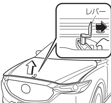
2. ボンネットのすき間に手を入れ、レバーを矢印の方向に倒したままボンネットを持ち上げます。
