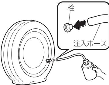
13. ボトルを逆さまにして持ち、手でボトルを押し、修理剤をすべてタイヤの中に注入します。
