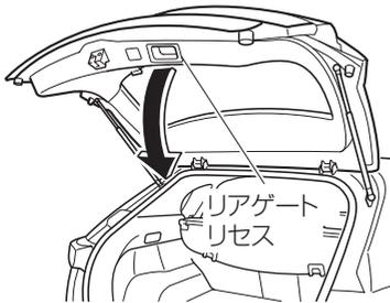
リアゲートをゆっくり下げて、押さえつけるように閉めます。リアゲートリセスを使用すると便利です。パワーリアゲートの操作については41ページの「パワーリアゲートの開閉 **グレード/仕様別装備**」をお読みください。
