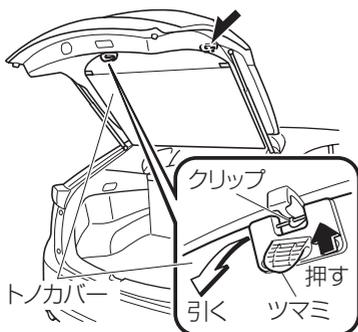
1. ツマミを持ってトノカバーを両手で持ち上げ、クリップから取りはずし、まき取らせます。
