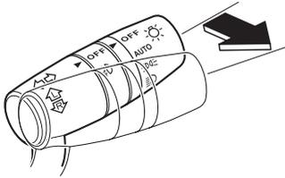
電源ポジションが ON のとき使用できます。ランプスイッチの位置に関係なく、レバーを引いている間ヘッドランプが上向き (ハイビーム) で点灯します。
