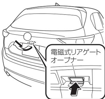
ドアを解錠し、電磁式リアゲートオープナーを押してリアゲートを持ち上げます。
