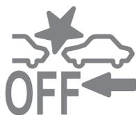
スマート・ブレーキ・サポート (SBS) を作動しないようにすると、スマート・ブレーキ・サポート (SBS) OFF 表示灯が点灯します。
