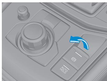
電源ポジションに関係なく、電動パーキングブレーキ (EPB) をかけることができます。ブレーキペダルをしっかりと踏み込み、電動パーキングブレーキ (EPB) スイッチを引き上げます。電動パーキングブレーキ (EPB) がかかり、メーター内の電動パーキングブレーキ (EPB) 表示/表示灯および電動パーキングブレーキ (EPB) スイッチの表示灯が点灯します。
