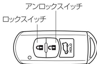
電源ポジションおよびランプスイッチが、次の状態のときにキーのアンロックスイッチを押し、車両がキーの信号を受信するとランプが点灯します。一定時間（30秒）経過すると消灯します。
