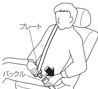
3. ベルトにねじれがないかを確認してから、プレートをバックルにカチッと音がするまで差し込みます。
