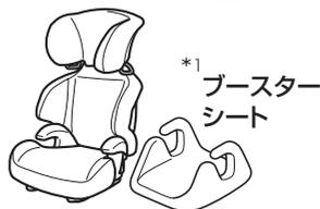
\*1 ブースターシートを使用するときは、必ず取り付けるシートのヘッドレストを取り付けてください。
