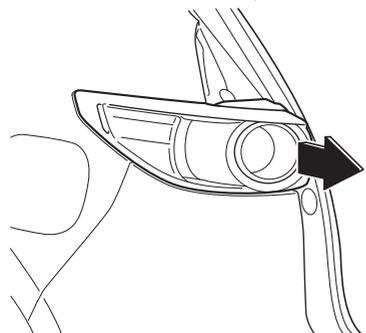
4. ユニットを車両後方に引き、ユニットを取りはずします。
