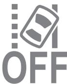
メーター内の、レーンキープ・アシスト・システム (LAS) & 車線逸脱警報システム OFF 表示灯が点灯します。
