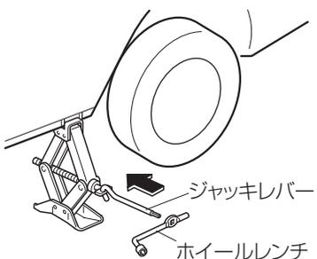
6. ジャッキにジャッキレバーをかけ、ジャッキレバーにホイールレンチを組み付けます。
