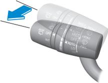
レバーをAUTOの位置にしているとき、レインセンサーが雨を感知すると、雨量に応じて、ワイパーが自動で作動します。スイッチをまわすと、雨に反応する感度を調節できます。
