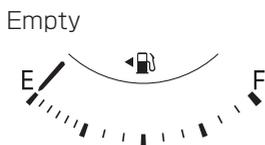
電源ポジションがONのとき、燃料の残量を示します。燃料が少なくなると、燃料残量警告灯が点灯します。早めに燃料を補給してください。
