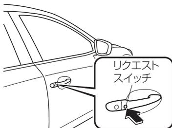
キーを携帯し、フロントドアのリクエストスイッチを押すと、すべてのドア、リアゲートが施錠 / 解錠します。
