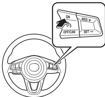
1. ON スイッチを押すと速度の設定ができる状態になります。同時にメーター内のクルーズメイン表示（白）が表示されます。
