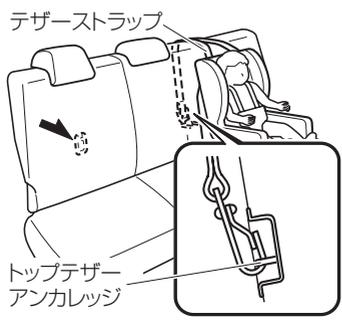
6. チャイルドシートのテザーストラップをイラストのようにトップテザーアンカレッジにかけます。
