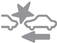
スマート・ブレーキ・サポート（SBS）作動中に表示（赤）が点滅します。
