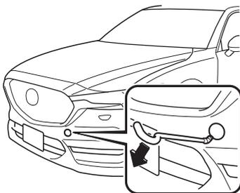
2. ジャッキレバーなどの先端に布を巻いてカバーを取りはずします。
