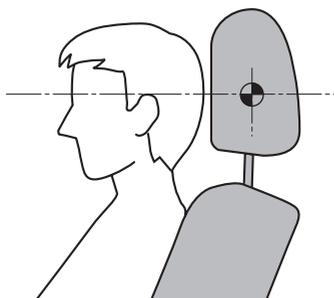
ヘッドレストの中央が、耳の上部と同じ高さになるように調節してください。
