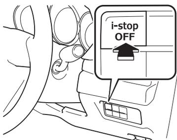
スイッチをチャイムが鳴るまで押しつづけると、i-stop の作動が解除され、メーター内の i-stop 警告灯（橙）が点灯します。もう一度チャイムが鳴るまで押しつづけると i-stop が作動可能な状態になり、i-stop 警告灯（橙）が消灯します。
