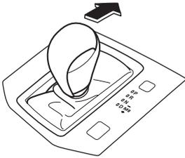
セレクトレバーを一側に動かすとシフトダウン（低速ギアに変速）します。
