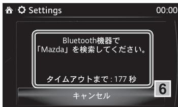
6. このメッセージが表示されている間に、Bluetooth®機器を操作して、Bluetooth®機器を検索します。
