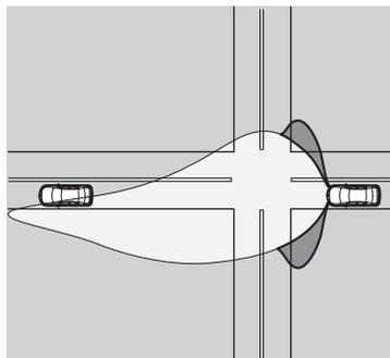
車速約40 km/h未満で走行中に、ヘッドランプ下向き (ロービーム) の照射範囲を拡大して照射します。
