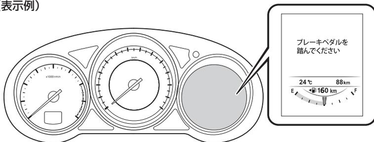
警告灯が同時に点灯 / 点滅したとき、またはマルチインフォメーションディスプレイにシンボルが表示されたときは、警告灯、またはシンボルの内容を確認してください。
