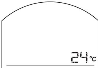
電源ポジションが ON のとき、外気温を表示します。
