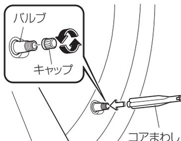
10. パンクしたタイヤのバルブからキャップを取りはずし、コアまわしの後ろでバルブ内のバルブコアを押し、タイヤの空気を完全に抜きます。
