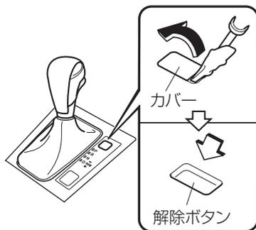
万一、セレクトレバーをPから操作できないときは、カバーをはずし、ブレーキペダルを踏み、マイナスドライバーなどで解除ボタンを押したまま、セレクトレバーボタンを押してセレクトレバーを操作します。
