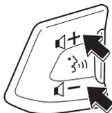
十、一 ボタンを操作して、音量を調節します。
