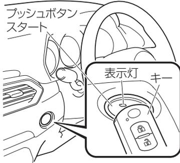
1. エンジンが完全に始動するまで、ブレーキペダルをしっかりと踏みます。
