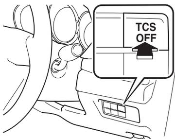
スイッチを押すと TCS が停止され、メーター内の TCS OFF 表示灯が点灯します。
