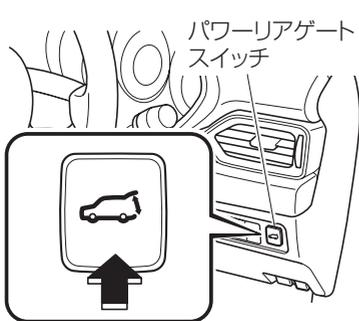
パワーリアゲートスイッチを約 1 秒以上押すと、非常点滅灯が 2 回点滅し、ブザーが鳴ったあと、自動で全開（全閉）します。
