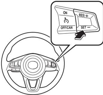
アクセルペダルを踏み、希望の速度になったところで SET - スイッチを押します。スイッチを操作しなければ、アクセルペダルから足を離すと、もとの設定速度にもどります。
