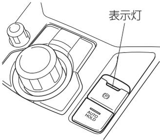
電動パーキングブレーキ (EPB) とは、電気モーターでパーキングブレーキをかける装置です。スイッチの表示灯は、電動パーキングブレーキ (EPB) をかけると点灯し、解除すると消灯します。電動パーキングブレーキ (EPB) スイッチ操作中は、スイッチの表示灯が点滅します。
