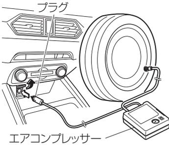
17. エアコンプレッサーのプラグを車内の電源ソケットに差し込み、電源ポジションを ACC にします。
