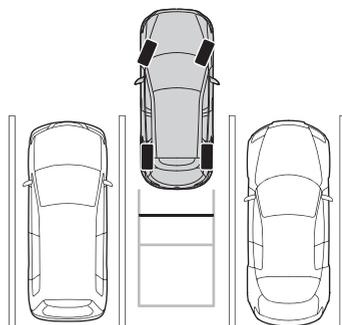
4. 車幅延長線と駐車スペースが平行になるようにハンドルを操作します。
