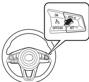
RES/ +スイッチを押したまま、希望の速度になったところで手を離します。スイッチを押してすぐに手を離すと、設定速度の調節（約 1 km/h）ができます。たとえば、スイッチを 4 回押すと、設定速度が約 4 km/h 上がります。
