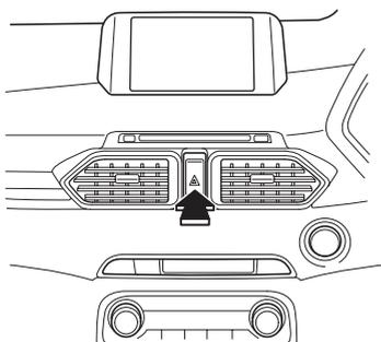
スイッチを押すとすべての方向指示灯および、メーター内にある非常点滅表示灯が点滅します。
