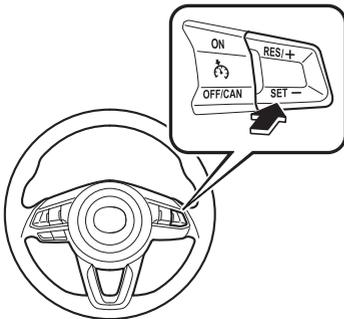
SET - スイッチを押し続け、希望の速度になったところで手を離します。スイッチを押してすぐに手を離すと、設定速度の調節 (約 1 km/h) ができます。たとえば、スイッチを 4 回押すと、設定速度が約 4 km/h 下がります。
