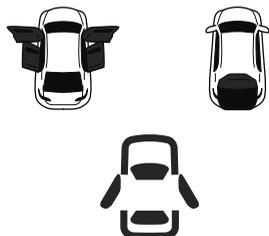
いずれかのドア/リアゲートが確実に閉まっていないときに表示/点灯します。
