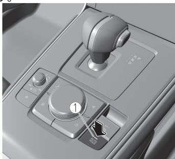
1. オートホールドスタンバイ表示灯
