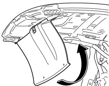
12. 開口部を軸にしてトップシーリングの後端を持ち上げます。
