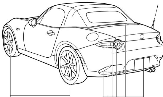
タイヤの空気圧、き裂、損傷
