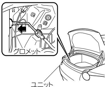
5. ボディー側に作業用の穴を確保するため、グロメットの上下を押さえながら、グロメットをユニット側に押し込みます。
