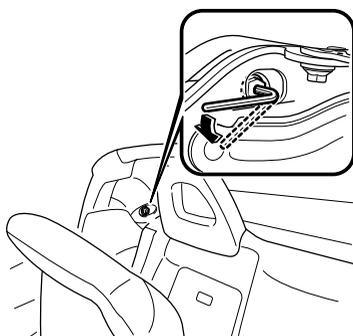
3. L型六角レンチ（大）を反時計回りにまわして、ボルトを少しゆるめます。
