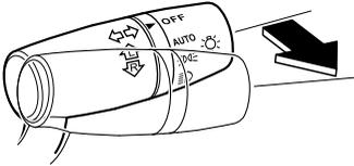
電源ポジションが ACC または OFF のときに、レバーを引くとヘッドランプが下向き（ロービーム）で点灯します。ドアを閉めてから一定時間経過すると消灯します。
