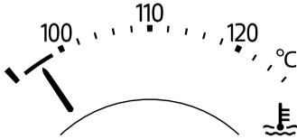
電源ポジションが ON のとき、エンジン冷却水の温度を示します。
