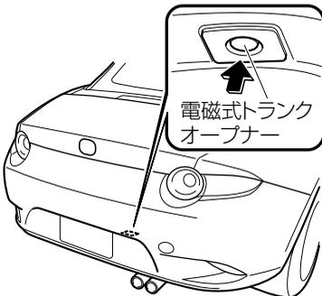
ドアを解錠し、電磁式トランクオープナーを押しトラン
