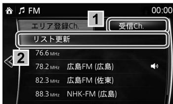
1. 受信 Ch. タブを選択します。本機のチューナーが実際に受信した放送局が昇順で表示されます。
