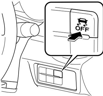
スイッチを押すと TCS/DSC が停止され、メーター内の DSC OFF 表示灯が点灯します。もう一度押すと TCS/DSC が作動可能な状態になり、DSC OFF 表示灯が消灯します。
