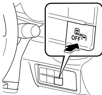
BSM OFF 表示灯が点灯するまで BSM OFF スイッチを押し続けると、BSM が OFF になります。BSM OFF 表示灯が消灯するまで BSM OFF スイッチを再度押し続けると、BSM は作動可能な状態にもどります。
