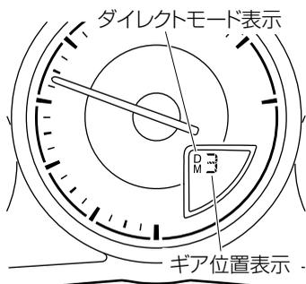
セレクトレバーを D の位置で走行中、ステアリングシフトスイッチを操作すると一時的にギア位置を切り替えることができます。
