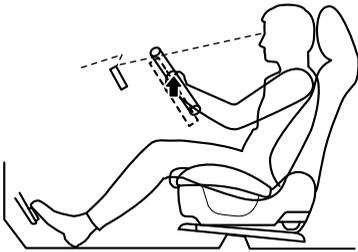
2. メーター類がしっかり見えるように、ハンドルの高さを調節します。
