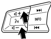
十、一 ボタンを操作して、音量を調節します。
