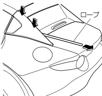
5. 1人がリアロープを上から押し付け、もう1人がロープを車両後方へ水平に”カチッ”と音がするまで強めに引っ張ります。
