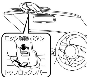
4. ロック解除ボタンを前方に押しながら、トップロックレバーを手前に引いてロックを解除します。
