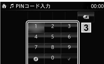
3. テンキーを使用して工場初期設定時の PIN コード [0000] を入力します。
