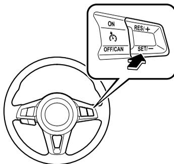
アクセルペダルを踏み、希望の速度になったところで SET/ースイッチを押します。
