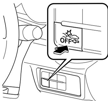
スマート・シティ・ブレーキ・サポート (SCBS) OFF 表示灯が点灯するまでスマート・シティ・ブレーキ・サポート (SCBS) OFF スイッチを押し続けると、SCBS R が OFF になります。スマート・シティ・ブレーキ・サポート (SCBS) OFF 表示灯が消灯するまでスマート・シティ・ブレーキ・サポート (SCBS) OFF スイッチを再度押し続けると、SCBS R は作動可能な状態にもどります。
