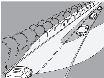
ヘッドランプ上向き (ハイビーム) の配光を前方車の部分だけ減光して照射します。
