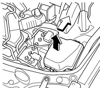
3) カバーを持ち上げながら後側にずらして、カバーを取りはずします。
