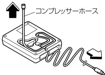
16. エアコンプレッサーからコンプレッサーホースと電源プラグを引き出します。
