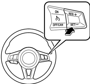
2. アクセルペダルの操作で希望の速度に調節します。
