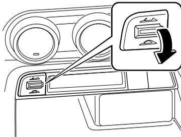
7. 清掃が終わったら、リトラクタブルハードトップスイッチを閉方向へ押し続けて、リアルーフを閉めてください。
