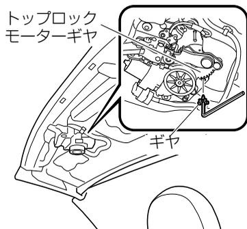
8. 車内から、六角レンチを差し込んだままのギヤの先端をトップロックモーターギヤ横の穴に差し込んでください。
