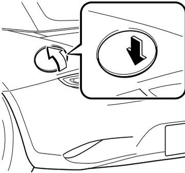
1. ドアを解錠した状態でフューエルリッドの端を押し、フューエルリッドを開きます。フューエルリッドは車の左側後方にあります。また、ドアの施錠/解錠に連動しています。
