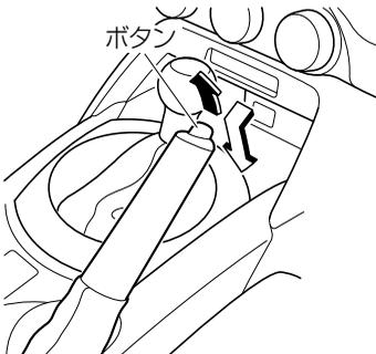
レバーを少し引き上げ、先端のボタンを押してもどします。
