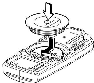
6. 新しい電池の十側を上にして差し込み、キャップをかぶせます。
