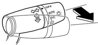
電源ポジションが ON のとき使用できます。ランプスイッチの位置に関係なく、レバーを引いている間ヘッドランプが上向き (ハイビーム) で点灯します。
