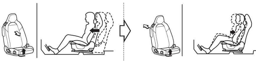
アクセルペダルとブレーキペダルの間に右足のかかとを置きます。かかとを床につけた状態でブレーキペダルに右足を乗せシートをできるだけ前へ動かします。
