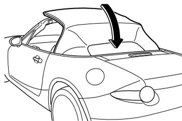
7. リアガラスを手で軽く押さえながら、ソフトトップを後方へ移動し、折りたたみます。
