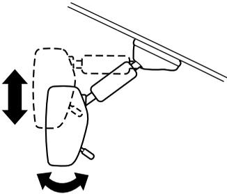
ミラー本体を動かして、後方が十分確認できるように調節します。
