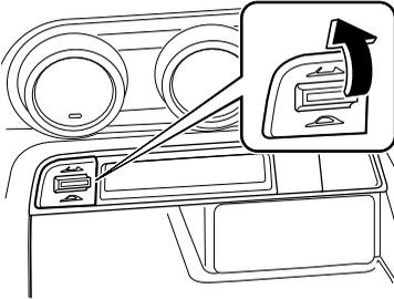
2. リアルーフが全閉の状態から上がりきるまで、リトラクタブルハードトップスイッチを開方向へ押し続けます。
