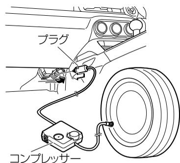
18. エアコンプレッサーのプラグを車内の電源ソケットに差し込み、電源ポジションを ACC にします。
