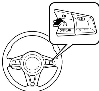
1. ON スイッチを押すと速度の設定ができる状態になります。同時にメーター内のクルーズメイン表示 (白)/表示灯 (橙) が点灯します。
