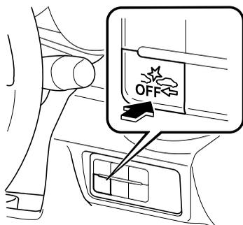
スマート・シティ・ブレーキ・サポート (SCBS) OFF 表示灯が点灯するまでスマート・シティ・ブレーキ・サポート (SCBS) OFF スイッチを押し続けると、アドバンスト SCBS が OFF になります。
