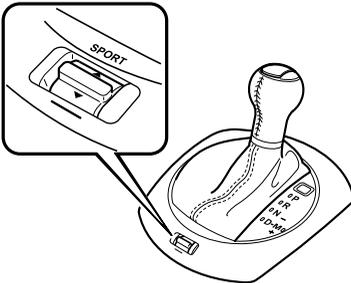
ドライブセレクションスイッチを**SPORT**側 (前方) に押すと、スポーツモードになります。ドライブセレクションスイッチを**OFF**側 (手前) に引くと、スポーツモードが解除されます。
