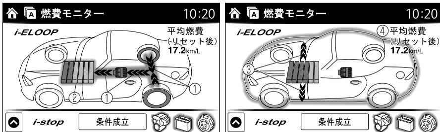
① 減速エネルギーを利用して発電した電気の量と、発電した電気が蓄電器に流れている状態を表示します。表示は発電量が増えると太くなります。
