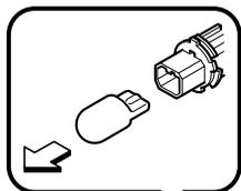
2. ソケットを反時計回りにまわして取りはずし、電球を抜き取ります。
