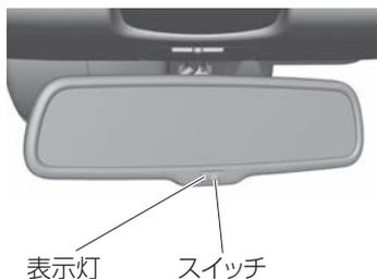
電源ポジションがONのとき、後続車からのヘッドランプの光を自動で軽減します。
