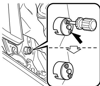
6. 持ち上げたカバーの間から手を入れ、キャップのネジを空回りするまでゆるめます。
