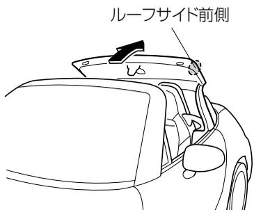
6. 車両の外側に立ち、ルーフサイド前側を持って、ソフトトップを車両後方へ引きます。
