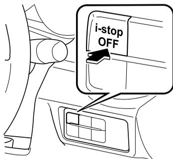
スイッチをチャイムが鳴るまで押しつづけると、i-stopの作動が解除され、メーター内のi-stop警告灯(橙)が点灯します。もう一度チャイムが鳴るまで押しつづけるとi-stopが作動可能な状態になり、i-stop警告灯(橙)が消灯します。
