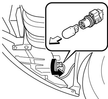
1. ソケットを反時計回りにまわして取りはずし、電球を抜き取ります。
