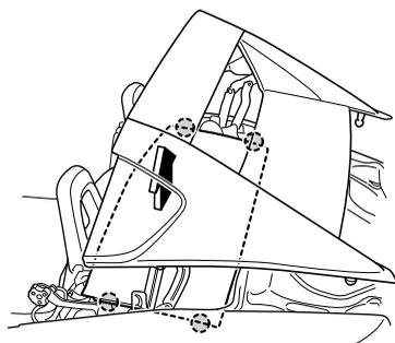
1. 車両の両側に立ちフロントルーフの前側と後側を持ち、フロントルーフを上方に引き出します。
