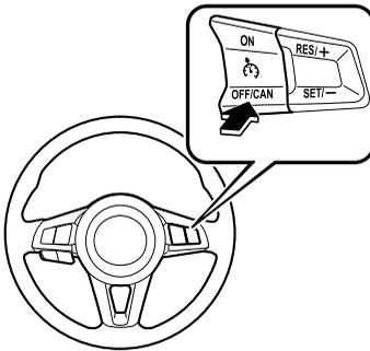
OFF/CAN スイッチを長押し、または 2 回押しと、クルーズコントロールが解除され、クルーズコントロール表示 (緑)/表示灯 (緑) とクルーズメイン表示 (白)/表示灯 (橙) が消灯します。
