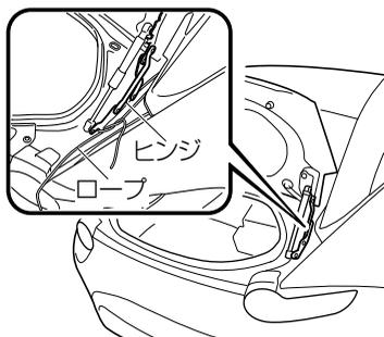
7. トランクを開け、ロープの末端をトランクのヒンジ部にしっかりと結びます。
