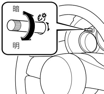
電源ポジションが ON で車幅灯が点灯しているときにパネルライトは減光されます。ただし、昼間にライトを点けたときなど、ライトセンサーが車両の周辺が明るいと感知した場合、パネルライトは減光されません。
