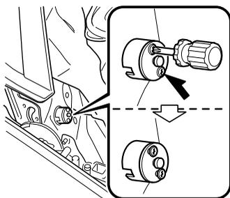
8. 持ち上げたカバーの間から手を入れ、キャップのネジを空回りするまでゆるめます。
