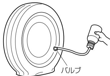
11. ボトルを逆さまにして持ち、手でボトルを圧迫し、修理剤をすべてタイヤの中に注入します。
