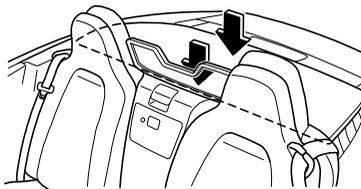
8. ソフトトップの後側を押さえた状態で、前側をカチッと音がするまで押さえつけます。ソフトトップをゆさぶり、確実にロックされたことを確認します。
