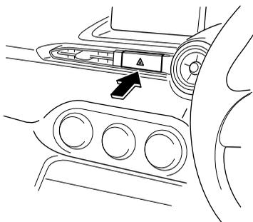
スイッチを押すとすべての方向指示灯および、メーター内にある非常点滅表示灯が点滅します。もう一度押すと消灯します。
