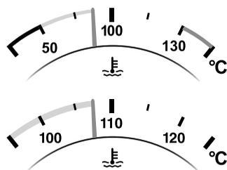
電源ポジションが ON のとき、エンジン冷却水の温度を示します。
