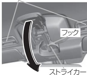
5. シートに座り、トップハンドルを持って、ソフトトップをフロントガラス側に押し当てます。フックがストライカーにかかっていることを確認し、トップロックレバーをゆっくり動かして、カチッと音がするまで押し上げます。
