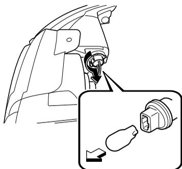
10. ソケットを反時計回りにまわして取りはずし、電球を抜き取ります。
