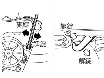
9. トップシーリングの開口部がフックに引掛けられる程度のすき間を残すように、六角レンチを回してフックを施錠方向に移動させます。
