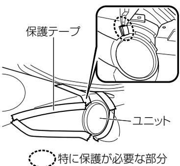
6. ボディーとユニットが干渉し、ボディーを傷つけるおそれがあるため、図のようにボディーに保護テープを貼り付けます。特に保護が必要な部分は、必ず保護テープを3枚重ねて貼り付けてください。
