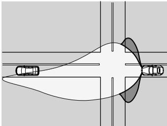
車速約 40 km/h 未満で走行中に、ヘッドランプ下向き (ロービーム) の照射範囲を拡大して照射します。
