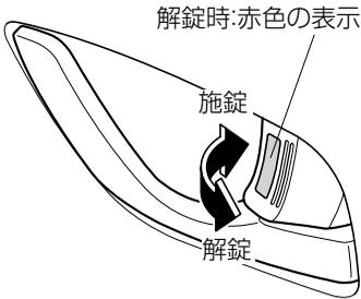
運転席ドアのロックノブを操作すると、すべてのドア、トランク、フューエルリッドの施錠/解錠ができます。
