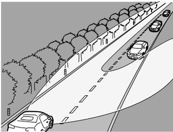
ヘッドランプ上向き (ハイビーム) の配光を前方車の部分だけ減光して照射します。
