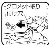
8. ユニットを取りはずすときは、ユニットのランプ部分(丸い部分)を手で支えながら、手順5でグロメットがはまっていた穴(グロメット取り付け穴)から指でユニットを押し、フックをはずします。
