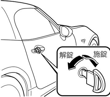
運転席ドアに、補助キーを差し込み、まわすとすべてのドア、トランク、フューエルリッドの施錠/解錠ができます。
