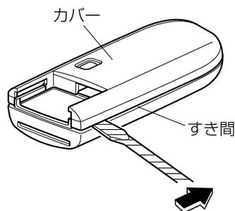
3. 保護テープを巻いたマイナスドライバーなどをすき間に差し込み、矢印の方向にスライドさせます。
