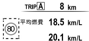
カメラで認識した交通標識を表示します。
