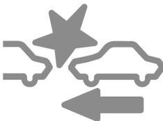
AT 誤発進抑制制御 [前進時] 作動中に表示灯 (赤) が点滅します。
