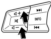
＋、－ボタンを操作して、音量を調節します。
