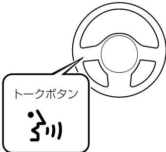
1. オーディオリモートコントロールスイッチのトークボタン
