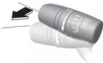
レバーを**AUTO** の位置にしているとき、レインセンサーが雨を感知すると、雨量に応じて、ワイパーが自動で作動します。スイッチをまわすと、雨に反応する感度を調節できます。
