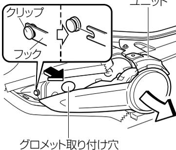
9. フックがはずれたら、ユニットを矢印の方向へ引いて取りはずします。
