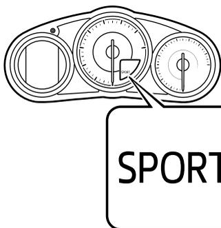
スポーツモードを選択しているときに、メーター内のセレクトモードインジケーターが点灯します。
