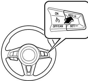
次のようなときは、クルーズコントロールが解除されクルーズコントロール表示 (緑)/表示灯 (緑) が消灯しますが、クルーズメイン表示 (白)/表示灯 (橙) は点灯したままです。車速が 30 km/h 以上であれば、RES/+ スイッチを押すと、もとの設定速度にもどります。
