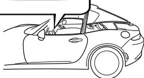
3. リアルーフが全開の状態になるまでリトラクタブルハードトップスイッチを開方向へ押し続けます。
