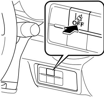
車線逸脱警報システム OFF スイッチを押します。メーター内の車線逸脱警報システム OFF 表示灯が消灯していることを確認します。車線逸脱警報システム OFF 表示灯が消灯するとシステムが待機状態になります。
