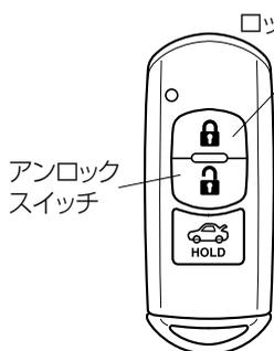
電源ポジションおよびランプスイッチが、次の状態のときにキーのアンロックスイッチを押し、車両がキーの信号を受信するとランプが点灯します。一定時間(30秒)経過すると消灯します。
