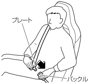
3. ベルトにねじれがないかを確認してから、プレートをバックルにカチッと音がするまで差し込みます。
