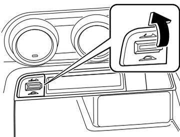
4. ルーフの開作動が完了するまで、リトラクタブルハードトップスイッチを開側に押し続けます。開作動が完了すると、チャイムが鳴り、作動表示灯が消灯します。
