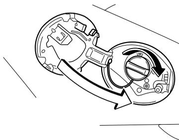
5. フューエルキャップを右に回し、カチッと1回音がするまで締め付けます。
