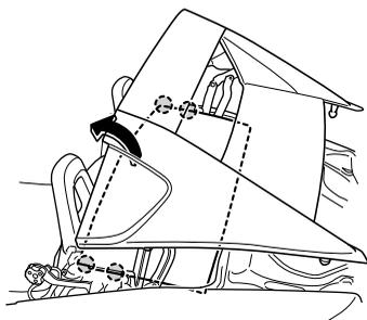
2. フロントルーフの後側の手をフロントルーフの前側に持ち替えて、フロントルーフを前方に引き出します。
