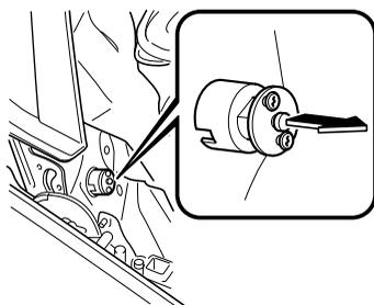
7. キャップを引いて、トランクのロックを解除します。
