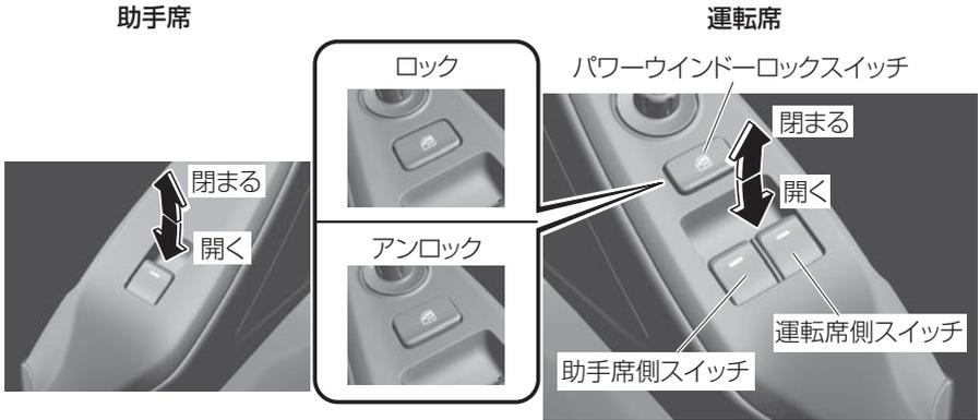
電源ポジションがONのとき、スイッチを押している間は開き、引き上げている間は閉まります。助手席の窓ガラスは、運転席ドアにあるパワーウィンドーロックスイッチをアンロックの位置にしているとき開閉できます。
