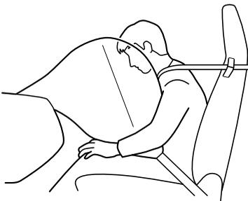
助手席エアバッグはインストルメントパネルに格納されています。助手席に同乗者がいなくても運転席エアバッグと同時に膨らみます。
