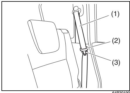
3 シートベルトのバックルを収納します。
