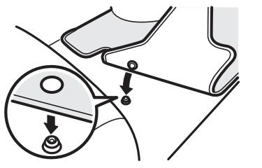
※ 運転席および助手席側のフロア（カーペット下）には、マツダ純正フロアマットを固定するための固定具（ホック）があります。
