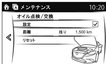
オイル点検/交換選択後、設定を選択し、交換距離を好みの距離に設定します。
