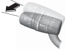
レバーをAUTOの位置にしているとき、レインセンサーが雨を検知すると、雨量に応じて、ワイパーが自動で作動します。スイッチをまわすと、雨に反応する感度を調節できます。
