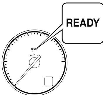
メーター内の READY インジケーターが点灯しているとき走行できます。ガソリンエンジンは状況により自動始動/自動停止します。
