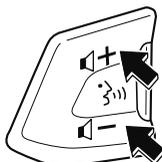
＋、－ボタンを操作して、音量を調節します。
