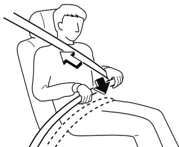
4. ベルトを腰骨のできるだけ低い位置にかけ、たるみがないようにベルトを引いて身体に密着させます。
