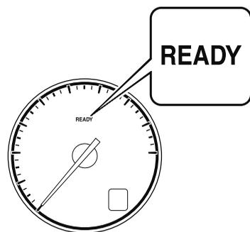
5. メーター内の READY インジケーターの点灯を確認します。READY インジケーターが点滅から点灯にかわり、チャイムが鳴ると正常にハイブリッドシステムは始動しています。
