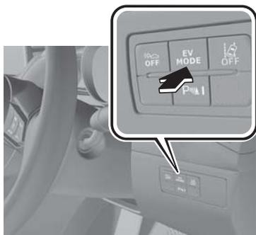
スイッチを押すことにより、EVドライブモードに切り替わります。EVドライブモードのときはEVドライブモード表示灯が点灯します。もう一度押すと、通常走行（ガソリンエンジンと電気モーターによる走行）にもどり、EVドライブモード表示灯は消灯します。
