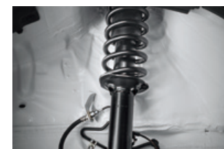
■フロントサスペンション: マクファーソンストラット式コイルスプリング
