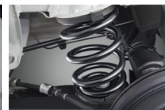
■リアサスペンション: トレーリング式コイルスプリング
