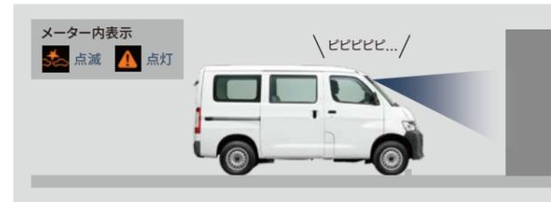
前方約4m以内に障害物などがあることをステレオカメラが検知している時に、シフトポジションを「前進」にしたままブレーキペダルと間違えるなどして必要以上にアクセルペダルを踏み込んだ場合、急発進を抑制します。
