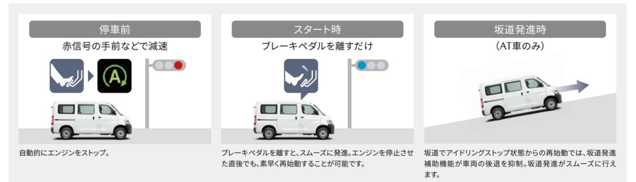
※5:シフトがDポジションの状態ではブレーキペダルを踏み、車速約9km/h以下になるとエンジンが自動的に停止します(エンジン停止には、いくつかの条件があります。詳しくは販売会社におたずねください)。
