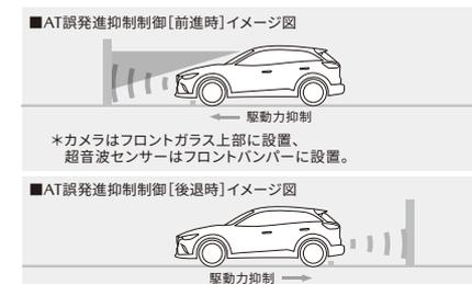
ペダルの踏み間違いによる誤発進を抑制する **AT誤発進抑制制御**
