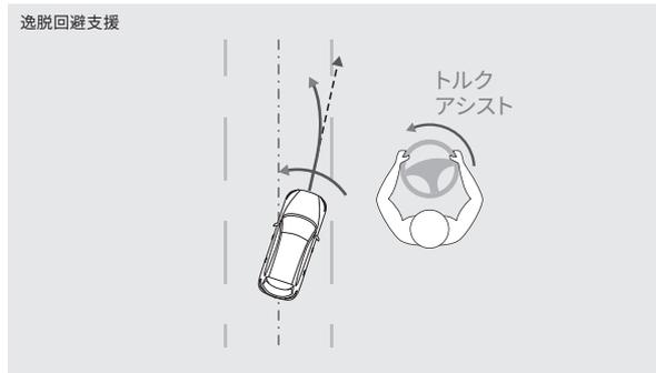
車線逸脱を制御する / 車線に沿った走行をアシストする
