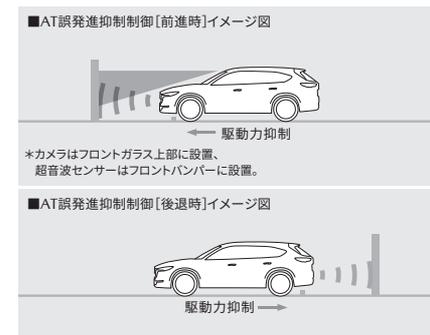
ペダルの誤操作による急発進を抑制する **運転支援機能**
