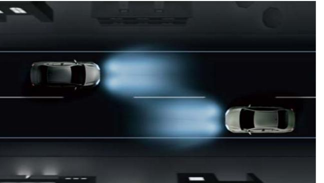
\*AHB:Automatic High Beam \*自車速度約30km/h以上で作動します。\*ハイビーム・ロービームの切替自動制御には、状況により限界があります。運転時には常に周囲の状況に注意し、必要に応じて手動で切り替えるなど、安全運転を心掛けてください。\*道路状況、車両状態および天候状態などによっては、作動しない場合があります。詳しくは取扱説明書をご覧ください。
