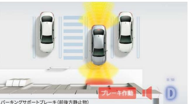
\*パーキングサポートブレーキ(前後方静止物)は衝突被害軽減ブレーキまで働くシステムではありませんが、必ず止まることを約束するものではありません。道路状況、車両状態および天候状態などによっては作動しない場合があります。また、衝突の可能性がなくてもシステムが作動する場合もあります。詳しくは取扱説明書をご覧ください。\*安全運転を行う責任は運転者にあります。常に周囲の状況を把握し、安全運転に努めてください。\*ソナーの検知範囲、作動速度には限界があります。必ず車両周辺の安全を確認しながら運転してください。\*運転者自身でパーキングサポートブレーキ(前後方静止物)の衝突被害軽減ブレーキ制御を試すことはやめください。\*パーキングサポートブレーキ(前後方静止物)の衝突被害軽減ブレーキが作動した場合でもブレーキ制御は2秒で解除されるため、そのまま前進・後退できます。また、ブレーキペダルを踏んでもブレーキ制御は解除されるため、再度アクセルペダルを踏むことで前進・後退できます。\*光式ナンバープレートは装着できません。
