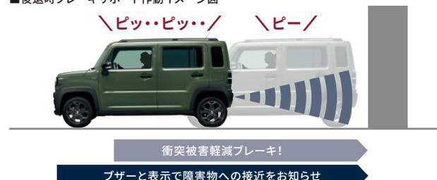
\*衝突被害軽減ブレーキ機能による車両停車後は、クリープ現象により後退しますので、必ずブレーキペダルを踏んでください。
