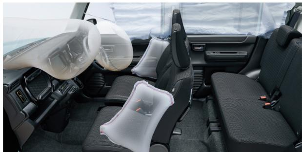
※7 SRS:Supplemental Restraint System(補助拘束装置) 運転席&助手席エアバッグは横方向や後方からの衝撃、横転および転覆した場合や正面からの衝撃が小さい場合には作動しません。カーテン&フロントサイドエアバッグは横方向からの衝撃を感知した場合、感知した側が作動しますが、正面や後方からの衝突時や衝撃が小さい場合には作動しません。すべてのSRSエアバッグはシートベルトをしたうえでの補助拘束装置です。シートベルトは必ず装着してください。
