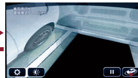
■車体を透かした形で見える「室内視点」イメージ図
