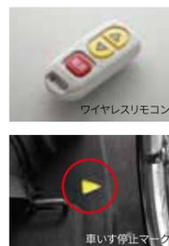
ベルトフリーボタンを再度押し、ウインチモードに切り替えます。ワイヤレスリモコンで電動ウインチを操作し、後輪の中心が車いす停止マーク(黄色い△印)付近に来るまで引き上げます。電動ウインチの巻き上げを待たずに、介助の方が手で押して乗車させることも可能です。
