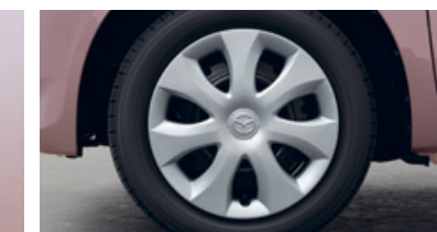
■155/65R14 75Sタイヤ&14インチスチールホイール+フルホイールキャップ
